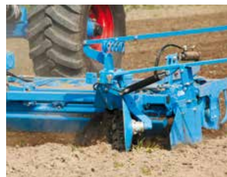
Направляющие диски для точного встречного движения
