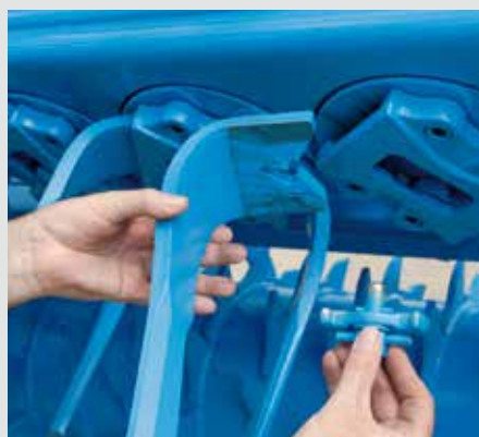
Быстрая замена ножей безболтового крепления
