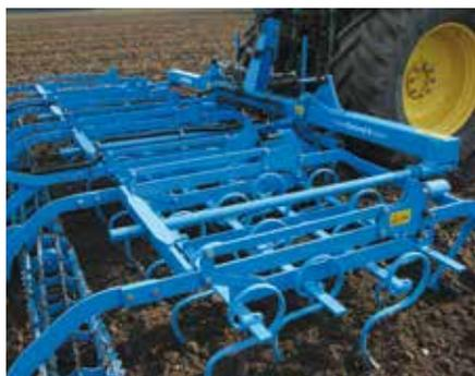
**Прочная рама из пружинной стали**
