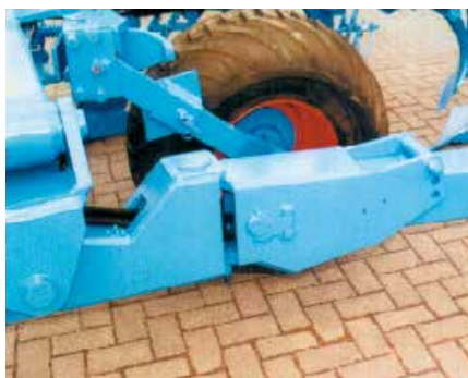
Простая регулировка точки тяги
