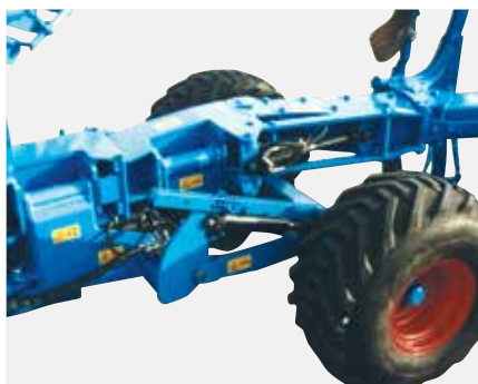
Шарнирное соединение рамы
